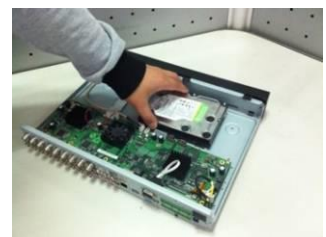
③ 把硬碟對準底板的四個孔放置
