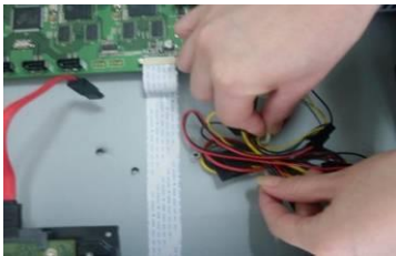
⑦ 解開監控主機內部的硬碟電源 線
