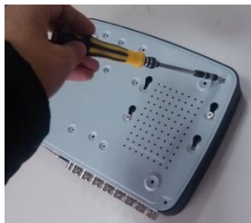
① 拆卸主機後面板及側面板的 固定螺絲
