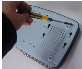
⑤ 將硬碟固定在底板
