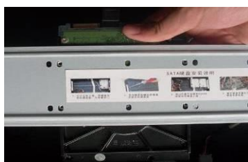
② 把硬碟對準硬碟支架的四個孔放置
