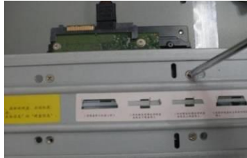
⑤ 用螺絲將硬碟固定
