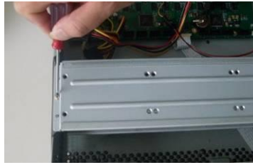
② 拆卸硬碟上支架
