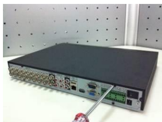
⑧ 固定主機後背板及側面板上的螺絲
