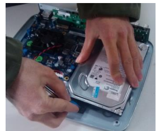
⑥ 插上硬碟線和電源線
