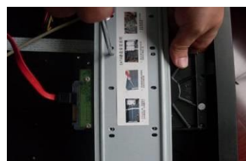
③ 用四個螺絲將硬碟固定
