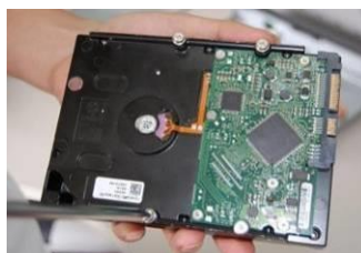
② 硬碟上固定四個螺絲（轉三圈）
