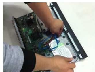
⑥ 插上硬碟線和電源線
