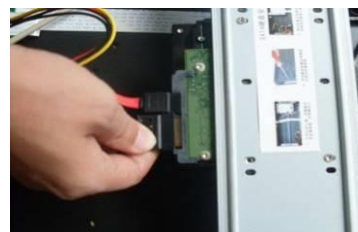
⑥ 插上硬碟電源線，最後合上主機殼蓋，予以固定
