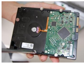
② 硬碟上固定四個螺絲（轉三圈）
