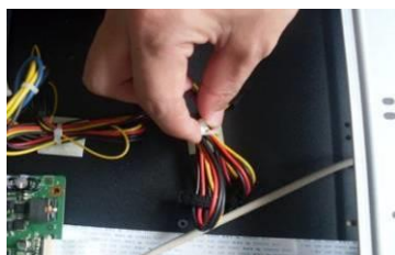
④ 解開監控主機內部的硬碟電源線
