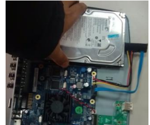
③ 把硬碟對準底板的四個孔放置
