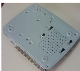
① 拆卸主機後面板及側面板的 固定螺絲
