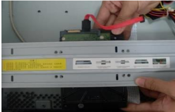
④ 把硬碟對準硬碟下支架的四個 孔放置
