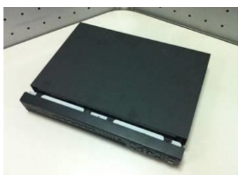
④ 翻轉設備，將螺絲移進卡口並固定
