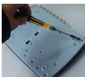
⑧ 固定主機後背板及側面板上的螺 絲
