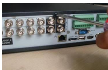
① 拆卸主機上蓋的固定螺絲
