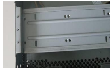
③ 拆卸硬碟上支架后，可看到 硬碟下支架
