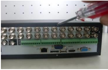
① 拆卸主機上蓋的固定螺絲
