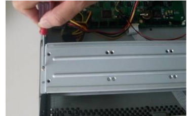
③ 拆卸硬碟上支架后，可看到 硬碟下支架
