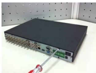
① 拆卸主機後面板及側面板的固 定螺絲
